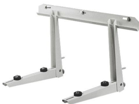
Staffe in lamiera acciaio stampato spessore 18/10. Fornita in coppia, completa di kit di fissaggio a muro e supporti antivibranti in gomma. Traversa cm. 80 , Montante cm. 40 , Braccio cm. 40. Spazio utile cm. 36 Portata max certificata max 100 Kg.
