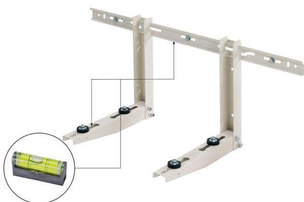
Staffe in lamiera acciaio stampato spessore 18/10. Fornita in coppia, completa di kit di fissaggio a muro e supporti antivibranti in gomma. Portata max certificata max 150 Kg. Traversa cm. 80 , Montante cm. 50 , Braccio cm. 50. Spazio utile cm. 43
